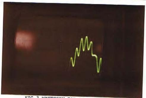
FIG. 3 WAVEFORM FOR AC CORONA
