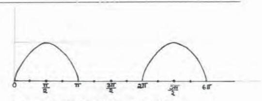
FIG.1. HALF WAVE RECTIFIED SINE WAVE
