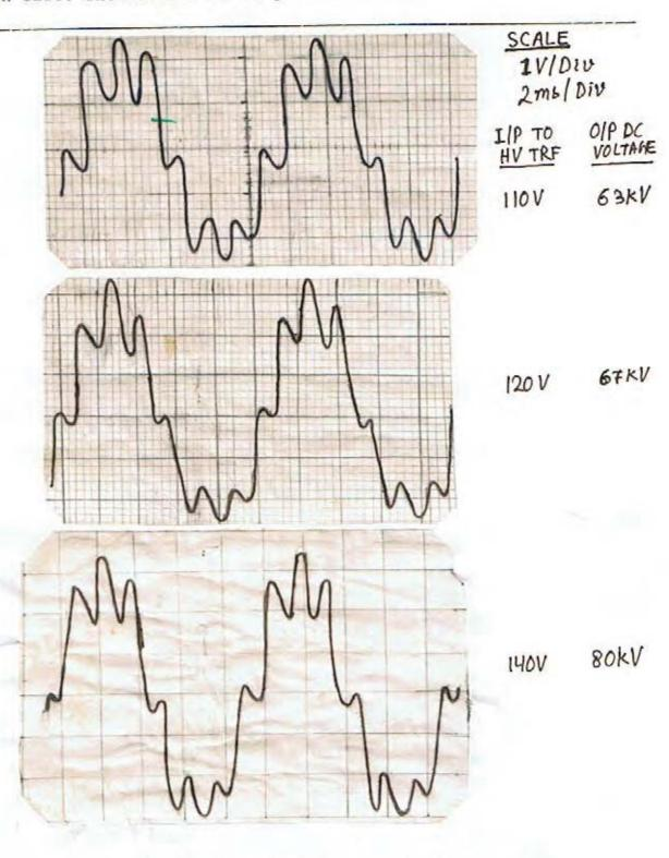
FIG.11. WAVEFORM RECEIVED IN CRO.
